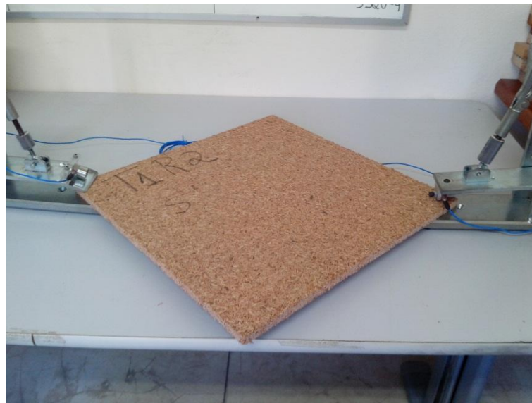
Figura 4 – Ensaio de stress wave utilizando a “garra” em placa de aglomerado.
