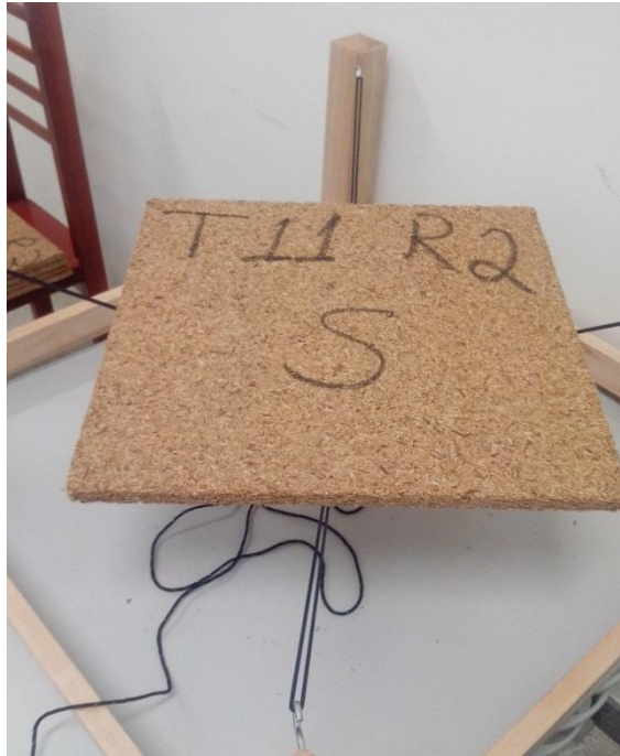
Figura 1 – Painel aglomerado sobre o suporte para ensaio de vibração livre em placa.
