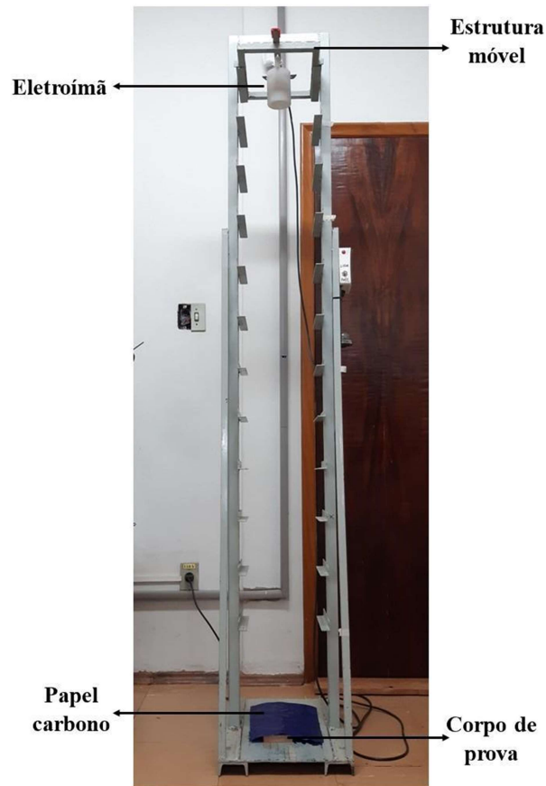
Figura 10 - Equipamento utilizado no ensaio de impacto da esfera de aço cadente
