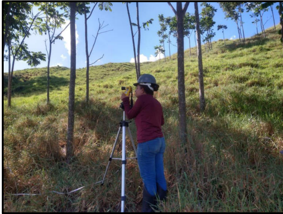
Figura 3 – Coleta dos diâmetros dos fustes das árvores em pé com uso do dendrômetro Criterion RD 1000
