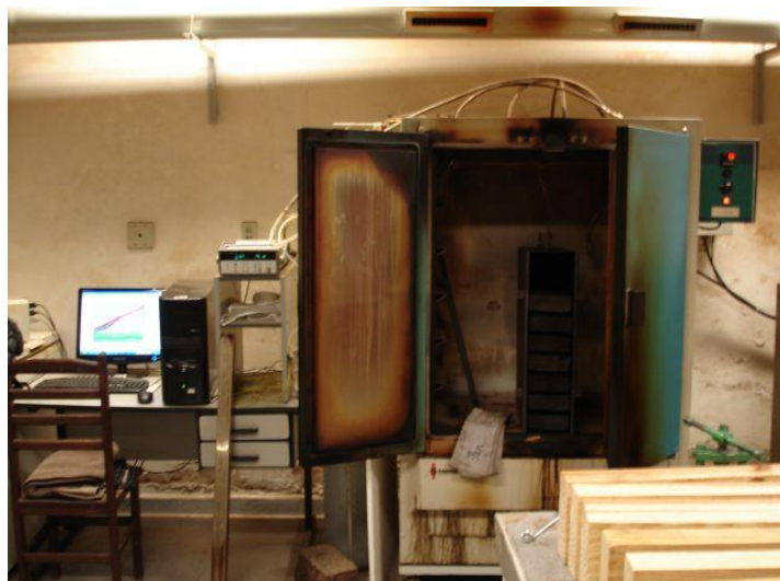
Figura 1 - Equipamentos e sistema de aquisição de dados para termorreificação.
