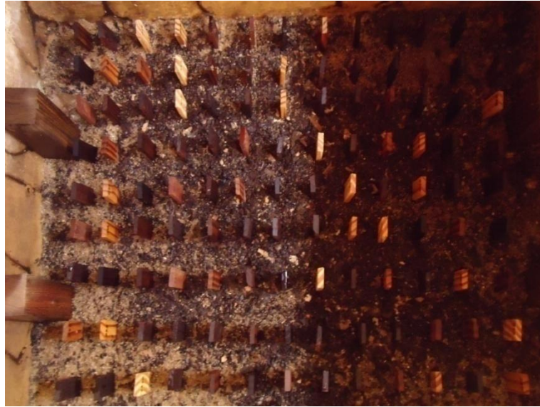
Figura 5 - Distribuição dos corpos de prova no ensaio de preferência alimentar.
