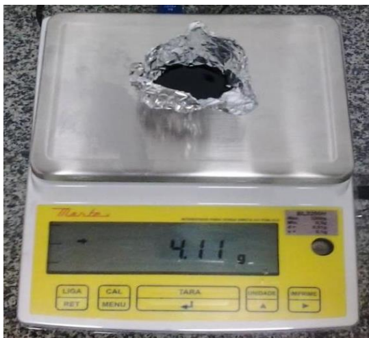
Figura 7 - Pesagem da massa úmida do adesivo para a determinação do teor de umidade, sendo o peso do alumínio desconsiderado.
