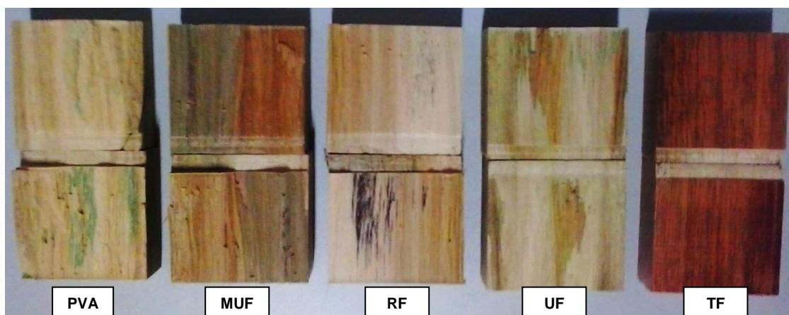
Figura 17 - Corpos de prova após ensaio de cisalhamento na linha de cola.
