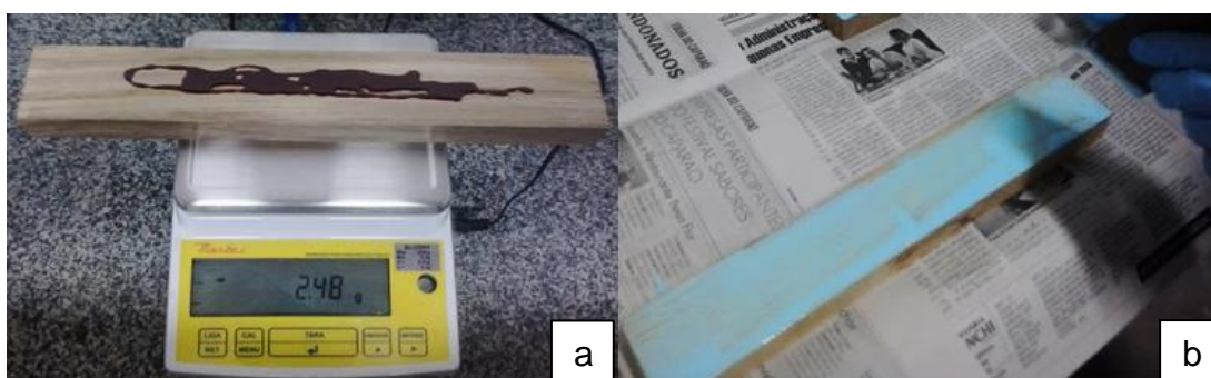
Figura 11 - Processo de colagem das taliscas: a) pesagem do tanino formaldeído e b) espalhamento do PVA.
