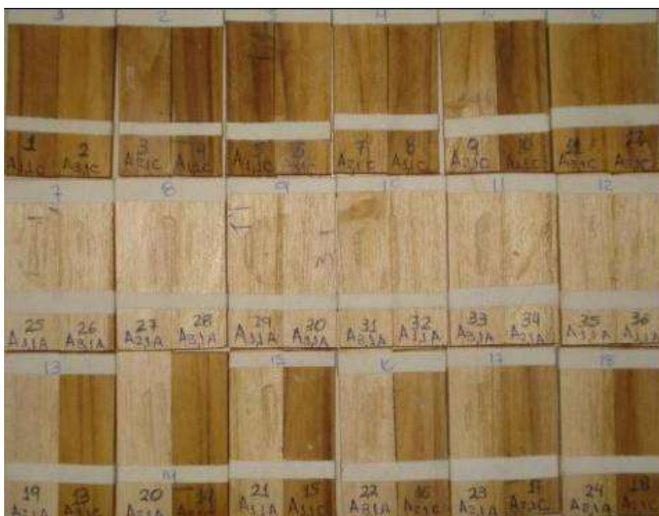
Figura 11 – Arranjo dos corpos de prova e desgaste provocado pelos cupins de madeira seca.
